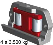
Per portate superiori a 3.500 kg l'esecuzione è con doppi rulli su bilanciere.
