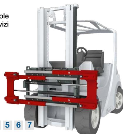
Il posizionatore con forche arrotondate T411ZR è stato appositamente disegnato per la movimentazione di carichi cilindrici come ad esempio bobine di carta e tessuto, coil, che possono così essere trasportati tra le forche arrotondate senza essere danneggiati dagli spigoli.
